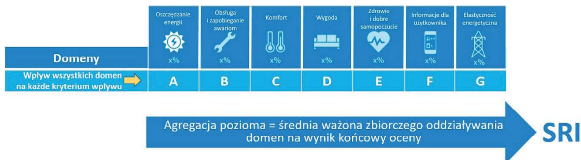
Rys. 10. Idea agregacji poziomej wyników kryteriów wpływu w celu obliczenia wartości końcowej wskaźnika SRI
