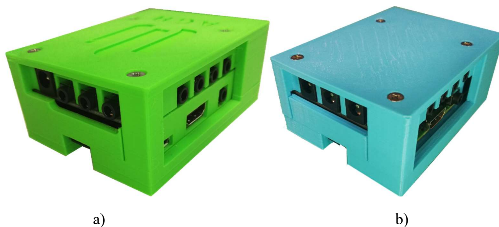
Rys. 5.11 Prototyp urządzenia Smart EMS a) wersja 1-fazowa pomiar odpływów, b) wersja 3-fazowa 63
