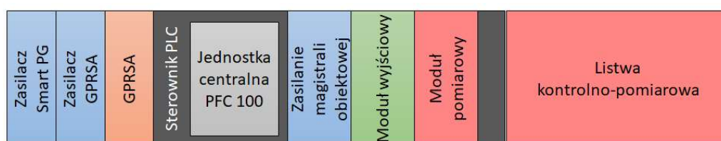
Rys. 4.3 Schemat blokowy konstrukcji Smart PG 44
