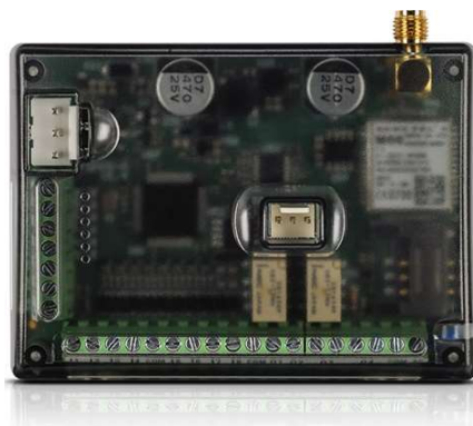
Rys. 3.4 Moduł komunikacji i powiadomień SMS, GPRS-A 25
