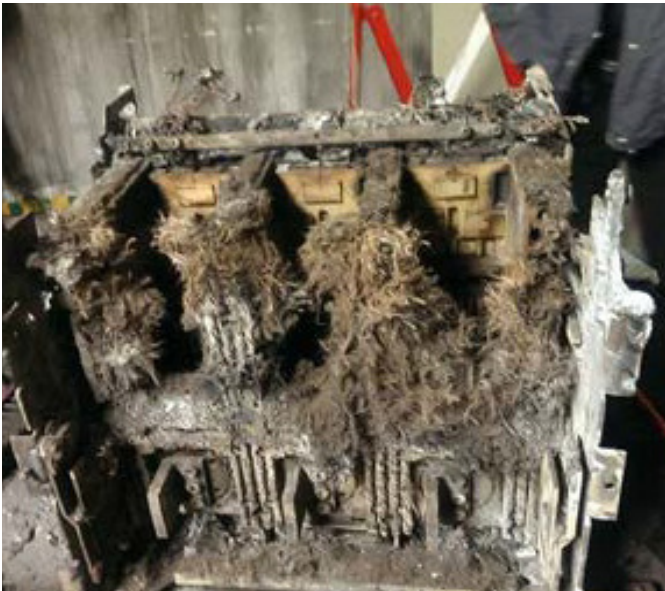
Ilustracja z monografii, przedstawiająca skutki braku konserwacji oraz eksploatacji akumulatorów w temperaturze większej od dopuszczalnej.
