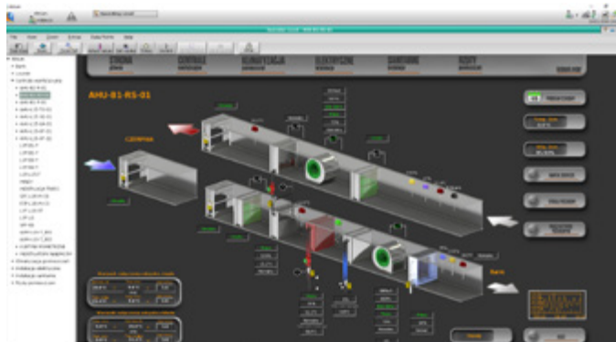
Rys. 1. Widok ekranu BMS dla centrali wentylacyjnej budynku.
